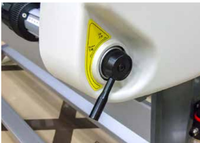
Ручка поднятия и опускания прижимного вала
