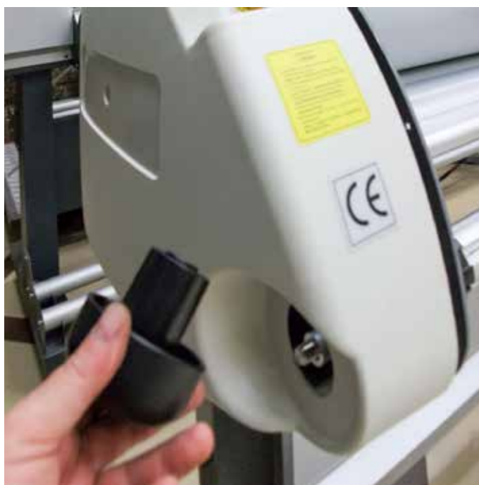
Шаг 18. Снять накладки валов
